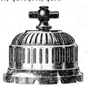
Es sei noch bemerkt, daß man zum Kontakt "hell" nur über die dunkleren Zwischenftufen gelangt, wodurch vermieden ift, daß die Augen plöglicher Helligkeit ausgesetzt werden können. Soll die Lampe als Nachtlicht benütt werden, wird man den Hebel auf "duntel" ftellen. In diefer Stellung giebt die Lampe gerade noch so viel Licht als für diesen Zweck nötig ist und dabei erspart man zirka 75 % Strom.
