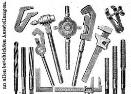
Gewindeschneid-Werkzeuge aller Gewindesysteme: Installationswerkzeuge; Normal - Gewindlehren; Normal-Caliber; Richtplatten etc.
