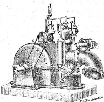
für Hochdruck, mit patentierten Löffelräder, mit oder ohne automatischem Regulator.
