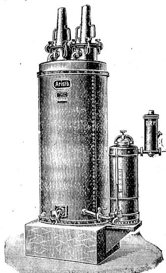
Der im In- und Ausland patentierte Acetylenapparat „Aristo“ ist ein verblüffend einfacher, ohne jeglichen Mechanismus automatisch arbeitender und gegen Kälte unempfindlicher Apparat, zur Erzeugung von luftfreiem, reinem und trockenem Acetylen-gas.
