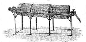
Einfache Werfen mit Holz- und Eisengestellen. Siebe auswechselbar.
