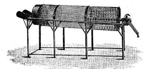
Einfache Werfen mit Holz- und Eisengestellen. Siebe auswechselbar.
