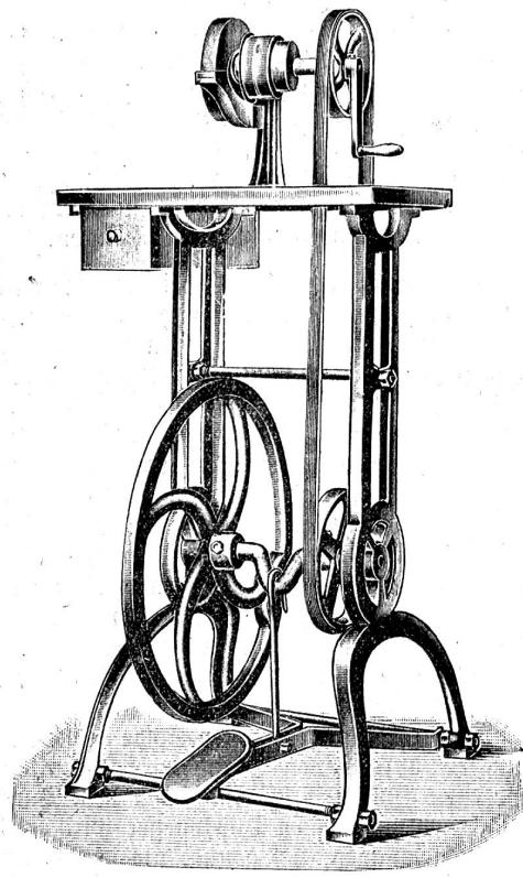
Diese Maschine für Handbetrieb, die in letzter Zeit in den Handel gebracht wurde, ist nun vom Erfinder auch für Fußbetrieb eingerichtet worden. Dadurch ist einem schon längst gehegten Wunsche manches Handwerkers, der keinen Kraftbetrieb hat, entsprochen.
