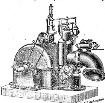
für Hochdruck, mit patentierten Löffelrädern, mit oder ohne automatischem Regulator.
