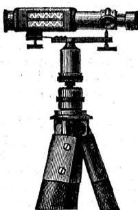
Seitwärts in der Wandung des Fernrohres ist eine Reversionslibelle parallel zur optischen Achse befestigt, derselben gegenüber der Spiegel. Von dem mit zwei nebeneinander gesetzten Linsen versehenen Ocular ist die mittlere die Vergrößerung gebende, die seitliche Linse (Lupenlinse) dient zur Sichtbarmachung des im Spiegel
