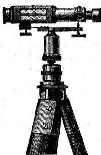
Seitwärts in der Wandung des Fernrohres ist eine Reversionslibelle parallel zur optischen Achse befestigt, derselben gegenüber der Spiegel. Von dem mit zwei nebeneinander gesetzten Linsen versehenen Ocular ist die mittlere die Vergrößerung gebende, die seitliche Linse (Lupenlinse) dient zur Sichtbarmachung des im Spiegel
