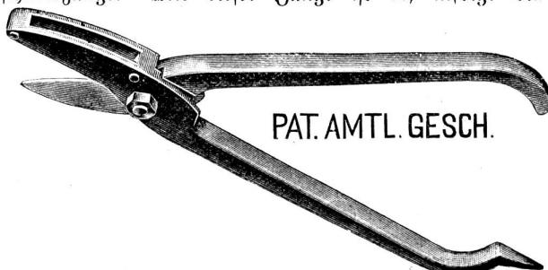
Doppelschnittes, der durch dieselbe beim Schneiden erzeugt wird, möglich, mit der geringsten Mühe das Rohr an jeder beliebigen Stelle vollständig glatt, d. h. ohne das Eisenblech auch nur im geringsten zu verbiegen, abzuschneiden.
