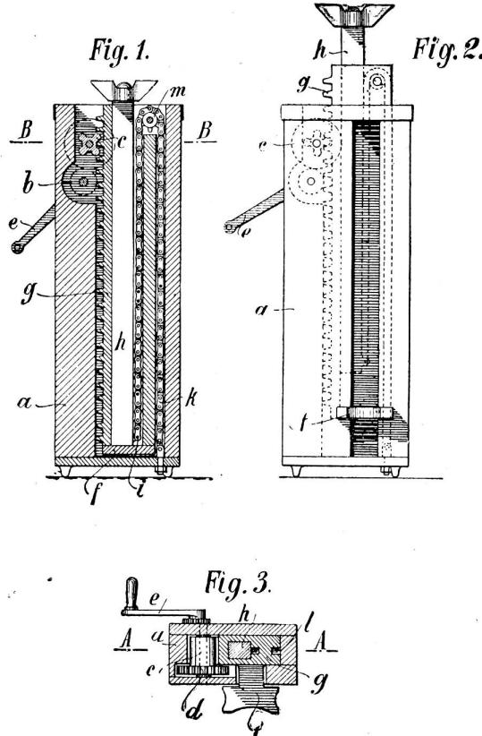
vom Centrum des Kettenrades m bis zum Fusse des Windenstocks um den gleichen Teil grösser, da jedoch die Länge der Kette k eine konstante ist, so vermindert sich die Länge des links vom Kettenrad m befindlichen Kettenteiles um den nämlichen Betrag, d. h. die Tragstange h verschiebt sich gegenüber der Zahnstange in der Höhenrichtung, wodurch der Hub verdoppelt wird.
