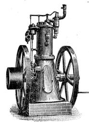
Unbedingt zuverlässiger und ruhiger Gang. Betrieb mit gewöhnlichem Lampenpetroleum (kein Benzin). Schmierung durchaus selbsthätig ohne Schmiergefässe, daher wenig Wartung, grosse Oelersparnis. Grösste Dauerhaftigkeit, einfachste Konstruktion. Konsum der Petroleum-Motoren circa 0,4 bis 0,6 Liter gewöhnliches billiges Lampenpetroleum pro Pferdekraft und Stunde Stunde.
