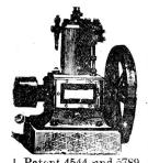
Unbedingt zuverlässiger und ruhiger Gang. Betrieb mit gewöhnlichem Lampenpetroleum (kein Benzin). Schmierung durchaus selbstthätig ohne Schmiergefässe, daher wenig Wartung, grosse Oelersparnis. Grösste Dauerhaftigkeit, einfachste Konstruktion, Konsum der Petroleum-Motoren eirca 0,4 bis 0,6 Liter gewöhn-liches billiges Lampenpetroleum pro Pferdekraft und Stunde
