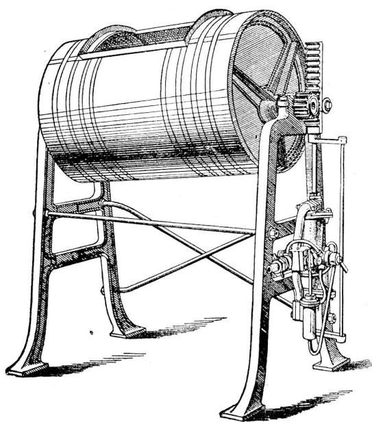
Durch exzentrische Zapfen seitlich der Trommel wird dieselbe durch die Umdrehung auf und nieder geschaukelt, d. h. die Wäsche in der Trommel abwechselungsweise links und rechts getrieben.
