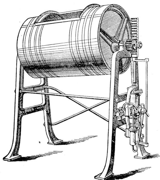
Durch exzentrische Zapfen seitlich der Trommel wird dieselbe durch die Umdrehung auf und nieder geschaukelt, d. h. die Wäsche in der Trommel abwechselungsweise links und rechts getrieben.
