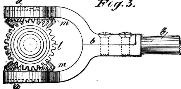
Das Andücken des Fräskopfes gegen die anzufräsende Stelle geschieht durch Anziehen der auf dem Bohrspindelende aufliegenden Flügelmutter, wodurch der Fräskopf gegen das als Gegenhalt dienende untere Ende der Bohrspindel und somit an die Arbeitsstelle angepreßt wird.
