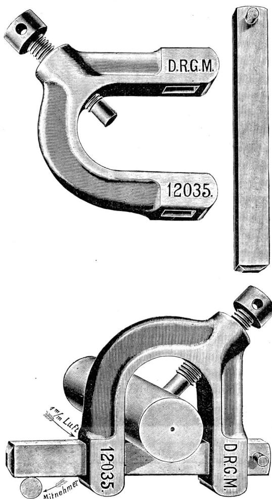
Vorstehende Abbildung stellt Limbrod's Drehherz dar, welches sich dadurch auszeichnet, daß es auf jedem Arbeitsstück mit größter Leichtigkeit auf- und abgespannt werden kann, ohne daß der zum Drehen bestimmte Gegenstand aus den Spalten der Drehbank gehoben werden muß.
