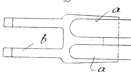
Das durch die Fig. 1—2 dargestellte Messer, das hauptsächlich zum Nuten dient, jedoch auch zum Spunden gebraucht werden kann, besitzt eine Schneide, welche an einer Klinke a sich befindet, die verschiebbar und austauschbar in einem Halter b angeordnet ist.
