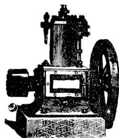
Unbedingt zuverlässiger und ruhiger Gang. Betrieb mit gewöhnlichem **Lampenpetroleum (kein Benzin)**. Schmierung durchaus selbstthätig ohne Schmiergefäße, daher wenig Wartung, grosse Oelersparnis. Grösste Dauerhaftigkeit, einfachste Konstruktion. Konsum der Petroleum-Motoren circa 0,4 bis 0,6 Liter gewöhnliches billiges Lampenpetroleum pro Pferdekraft und Stunde
