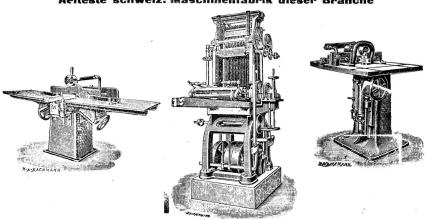
Vollgatter, Bandsägen, Circularsägen für Tischlereien und zum Schneiden von Brennholz, Dickenhobelmaschinen, Abricht-Langholzfräsen, Kehlmaschinen mit allen nötigen Einsätzen. Dickenhobelmaschinen, Abrichtmaschinen, combinierte Hobel- und Abrichtmaschinen, Lattenkreissägen, Pendelfräsen, automatische Hobelmesserschleifapparate, Langlochbohr- und Stemmmaschinen in gediegenster Ausführung und den neuesten Verbesserungen. Echleifsteine mit Handschleifapparaten.
