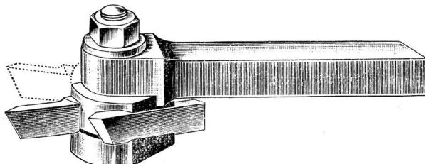
In erster Linie kann der gleiche Stahlhalter für links oder rechts in jeder beliebigen Stellung verwendet werden, sowohl für Gewinde, Seiten- und Abstechstahl. Derselbe ist auch bereits schon zur größten Zufriedenheit als Hobelstahl in Anwendung gebracht.
