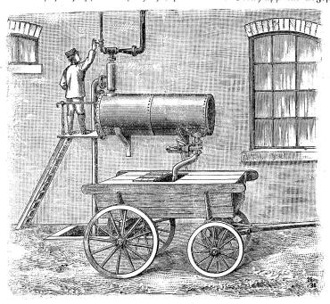
über dem Erdboden angebracht, daß sein Inhalt in einen untergeschobenen Wagen frei abfließen kann. Derselbe, zweckmäßig aus Eisen angesertigt, ist mit einem Dampsstrahlluftsauger, sowie mit einer nach der Grube führenden Saugleitung sest verbunden. Die Ablaufleitung, die zum Transportgesäße sührt, ist durch einen durch Deffnen der Ablaufschieber in den untergeschobenen Wagen entleert.
