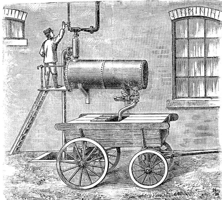
über dem Erdboden angebracht, daß sein Inhalt in einen untergeholbenen Wagen frei abfließen kann. Der selbe, zweckmäßig aus Eisen angefertigt, ist mit einem Dampfstrahlrohrsauger, sowie mit einer nach der Grube führenden Saugleitung fest verbunden. Die Ablauftleitung, die zum Transportgefäß führt, ist durch einen
