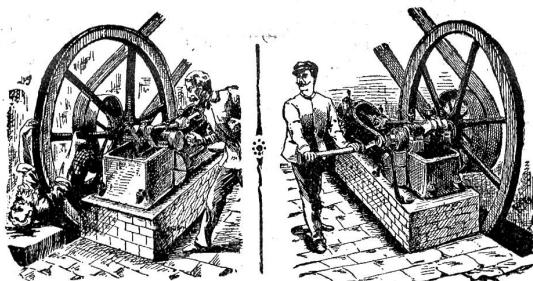
führung bedeutend weniger Unfälle, welche mit schweren, oft tödlichen Folgen begleitet waren, konstatiert worden sind. Jeder, welcher das mühsame Andrehen von Hand an den Schwungrädern erfahren, kennt auch die Wirkung der gefährlichen Fehlexplosionen und wird somit diese epochemachende, sicher-wirkende Neuheit nur begrüßen können.
