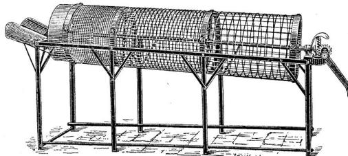
**Doppelwerfen** auf einen Wurf 3 und 4 Sorten erzeugend, **einfache Werfen** mit Holz und Eisenrahmen, **Handsiebe** für Maurer, Giessereien etc., **Drahtgeflechte** bis zu 10 Millimeter Drahtstärke.
