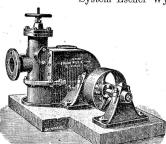
rür Hochdruck, mit patentierten Löffelrädern, mit oder ohne automatischem Regulator.
