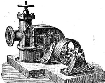
für Hochdruck, mit patentierten Löffelrädern, mit oder ohne automatischem Regulator.
