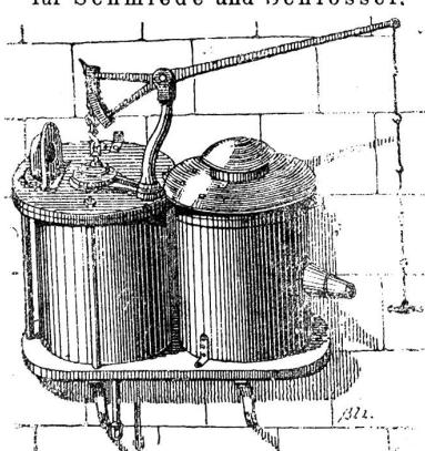
Cilindergebläse, Blasbälge Ventilatoren.
