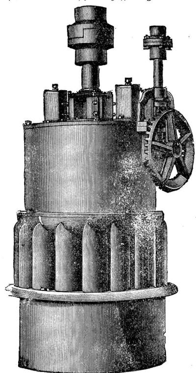
Einige Konstrukteure haben bei vollem Wasser ein gleiches Ertragnis erzielt, aber keinem andern ist es gelungen, einen ebenso hohen Durchschnittseffekt wie mit der „Herkules“-Turbine, bei beliebiger Speisung, zu erreichen.
