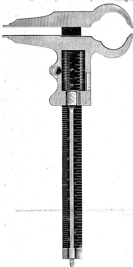
Der am Kaliber angebrachte nach unten zugespitzte Stab gestattet auch die Tiefe der Löcher schon von 2 mm an zu messen und macht besonders die leichtere Bestandteile dieses Kaliber zu dem so beliebten Maßwerkzeug.
