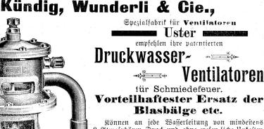
Können an jede Wasserseitung von mindestens 3 Atmosphären Druck und ohne wesen liche Unfosten an jede Esse angeschlossen werden. [23+a
