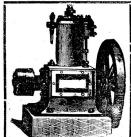
Unbedingt zuverlässiger und ruhiger Gang. Betrieb mit gewöhnlichem Lampenpetroleum (kein Benzin). Schmierung durchaus selbsthätig ohne Schmiergefässe, daher wenig Wartung, grosse Oelersparnis. Grösste Dauerhaftigkeit, einfachste Konstruktion. Konsum der Petroleum-Motoren eirea 0,4 bis 0,6 Liter gewöhnliches billiges Lampenpetroleum pro Pferdekraft und Stunde.
