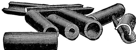
Riemenscheibe auf verschiedene, ungleich dicke Wellen montiert werden kann. Diese Büchsen werden aus einem Stück vollständig getrockneten im Ofen ganz ausgeböhrten Hartholz gefertigt und erst nachdem solche auf einer Drehbank möglichst exakt aus- und abgedreht worden sind, in zwei Teile gespalten.
