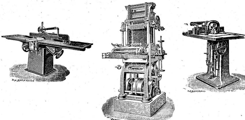
**Vollgatter, Bandsägen, Cirkularsägen** zum Schneiden von Brennholz und für die Tischlerei, **Langholzfräsen, Kehlmaschinen**, mit allen nötigen Einstücken. Ein-, drei- und vierseitige **Walzenhobelmaschinen, Abrichtmaschinen**. Hobelmesserschleifapparate. **Langlochbohr- und Stemm - Maschinen** in gediegenster Ausführung und den neuesten Verbesserungen.
