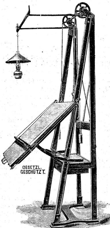
Die Reisschiene wird durch Gegengewichte ausgeglichen und mittels endloser, diagonal über Rollen laufender Schnur genau parallel geführt, wodurch die Reisschiene von jeder beliebigen Stelle aus mit Leichtigkeit hin und her bewegt werden kann und dem Zeichner ein rasch und sicher Arbeiten gestattet.
