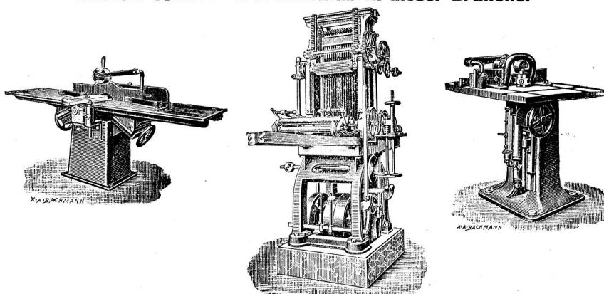
Vollgatter, Bandsägen, Cirkularsägen zum Schneiden von Brennholz und für die Tischlerei, Langholzfraise, Kehlmaschinen, mit allen nötigen Einstücken. Ein-, drei- und vierseitige Walzenhobelmaschinen, Abrichtmaschinen. Hobelmesserschleifapparate. Langlochbohr- und Stemm-Maschinen in gediegenster Ausführung und den neuesten Verbesserungen.
