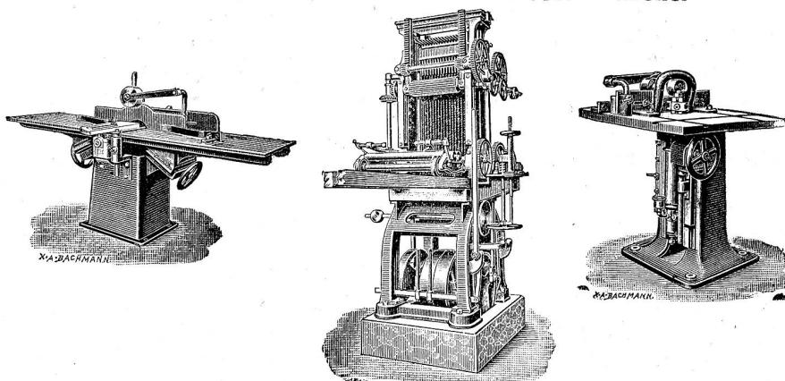
**Vollgatter, Bandsägen, Cirkularsägen** zum Schneiden von Brennholz und
