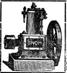
Unbedingt zuverlässiger und ruhiger Gang. Betrieb mit gewöhnlichem Lampenpetroleum (kein Benzin). Schmierung durchaus selbstthätig ohne Schmiergefässe, daher wenig Wartung, grosse Oelersparnis. Grösste Dauerhaftigkeit, einfachste Konstruktion. Konsum der Petroleum-Motoren circa 0,4 bis 0,6 Liter gewöhn-tiches billiges Lampenpetroleum pro Pferdekraft und Stunde
