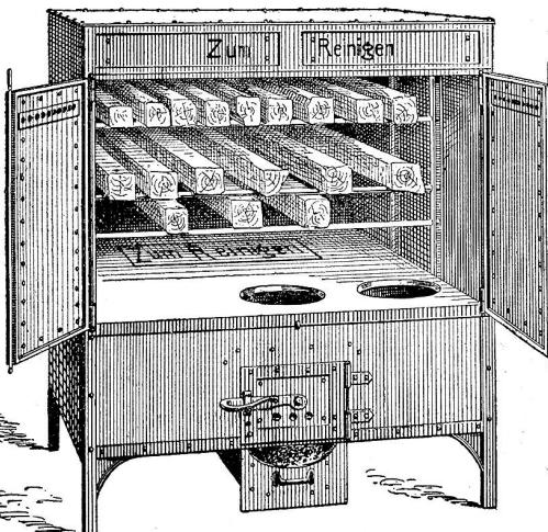
Dieser Ofen ist der einzige bestehende liegende Fournierofen, in welchem Zink- oder Holzulagen vom Feuer abgeschlossen, ohne zu verbrennen, von der Luft gewärmt werden können.
