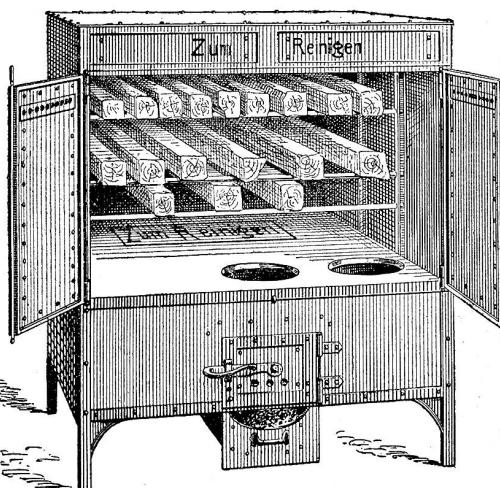
Dieser Ofen ist der einzige bestehende liegende Fournierofen, in welchem Zink- oder Holzulagen vom Feuer abgeschlossen, ohne zu verbrennen, von der Luft gewärmt werden können.
