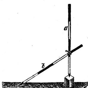
Stein eine Stange keinen Halt hatte, oder aber es mußten vorher Löcher zur Aufnahme der Meßstangen in die Steine gemeißelt werden. Mit Hilfe des Doppelringes kann man einen Fluchtstab genau senkrecht auf die Mitte des Grenzsteins zu stellen, wie nebenstehende Figur zeigt.
