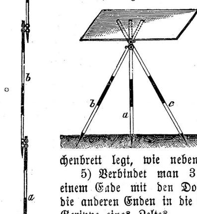
4) Sind die Doppelringe zur Herstellung eines Feldtisches sehr bequem zu verwenden, indem man 3 Fluchtstäbe a, b, c in den Erdboden steckt, sie in der Mitte mit den Ringen verbindet und darauf ein Brett legt, wie nebenstehende Figur zeigt.
