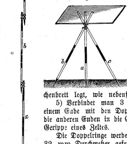
4) Sind die Doppelringe zur Herstellung eines Feldstisches sehr bequem zu verwenden, indem man 3 Fluchtstäbe a, b, c in den Erdboden steckt, sie in der Mitte mit den Ringen verbindet und darauf ein Ziehchenbrett legt, wie nebenstehende Figur zeigt.
