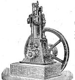
stehender und liegender Konstruktion bis 35 Pferdekräfte. Betrieb mit gewöhnlichem Petroleum, 6 bis 8 Cts. pr. Pferdekraft und Stunde. 1593a
