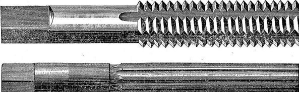
**Schneidkluppen neuester Konstruktion für Gasrohre.**
