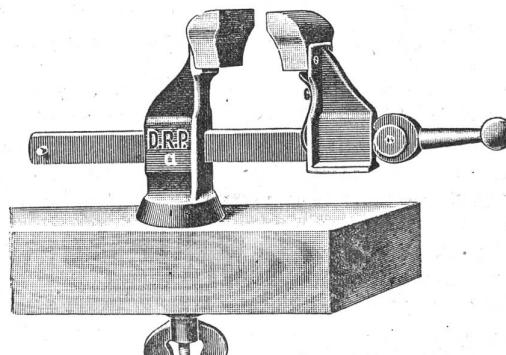
Mit Hilfe des Griffes a schiebt man die vordere Backe an das Arbeitsstück, drückt den Griff nach unten und das Stück sitzt absolut fest. Der Schraubstock hat ferner die Unmöglichkeit, an jede Hobel- und Werkbank durch die Schraube mit Flügelmutter schnell befestigt zu werden und ist nach jeder Seite hin drehbar. Abnutzung und Reparatur ist gänzlich ausgeschlossen. Gewicht ca. 10 kg. Erhältlich zum Preise von Fr. 16 bei J. Schwarzenbach, Genf.
