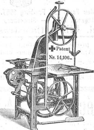
Durch Anordnung der Kugellager ist die geringste Reibung, dadurch der leichteste Gang erzielt und damit die Leistungsfähigkeit auf das höchste, was von einer Bandsäge für Hand und Fussbetrieb verlangt werden darf, gesteigert.
