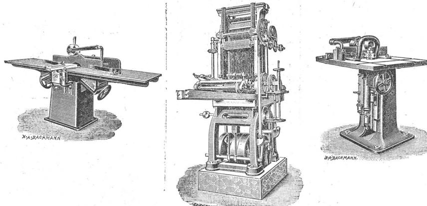
Vollgatter, Bandsägen, Cirkularsägen zum Schneiden von Brennholz und für die Tischlerei, Langholzfäisen, Kehlmaschinen, mit allen nötigen Ein-sätzen. Ein-, drei- und vierseitige Walzenhobelmaschinen, Abrichtmaschinen. Hobelmesserschleifapparate. Langlochbohr- und Stemm-Maschinen in ge-diegenster Ausführung und den neuesten Verbesserungen.
