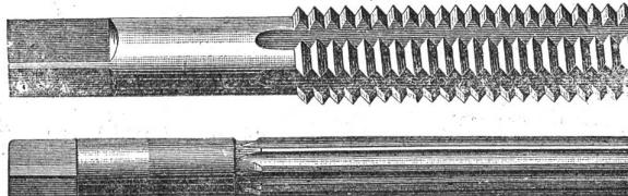
Schneidkluppen für Gasrohre neuester Konstruktion.
