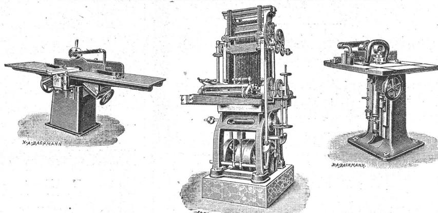
Vollgatter, Bandsägen, Cirkularsägen zum Schneiden von Brennholz und für die Tischlerei, Langholzfraise, Kehlmaschinen, mit allen nötigen Einstellungen. Ein-, drei- und vierseitige Walzenhobelmaschinen, Abrichtmaschinen. Hobelmesserschleifapparate. Langlochbohr- und Stemm-Maschinen in geübungster Ausführung und den neuesten Verbesserungen.
