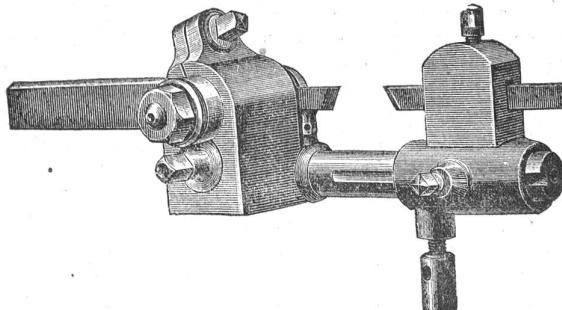
Obiger Gewindeschneid-Stahlhalter kann sowohl für Spitz- als für Flachgewinde benutzt werden und sind dabei nur die Stähle zu ändern. Dieselben werden aus Flach- und Vierkantstahl hergestellt und werden bloß vorn auf den Schnitt geschliffen, müssen daher nicht geschmiedet werden,
