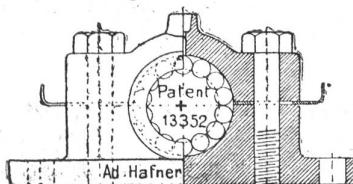
Diese einfachsten aller Kugellager können bei den meisten Maschinen und Transmissionen etc. mit dem grössten Vorteil verwendet werden, da in Folge der fast auf Null reduzierten Reibung ein sehr leichter Gang erzielt und daher sehr viel Kraft erspart wird. — Nach dem gleichen System fabriziere auch Leerrollen und Stellringe.
