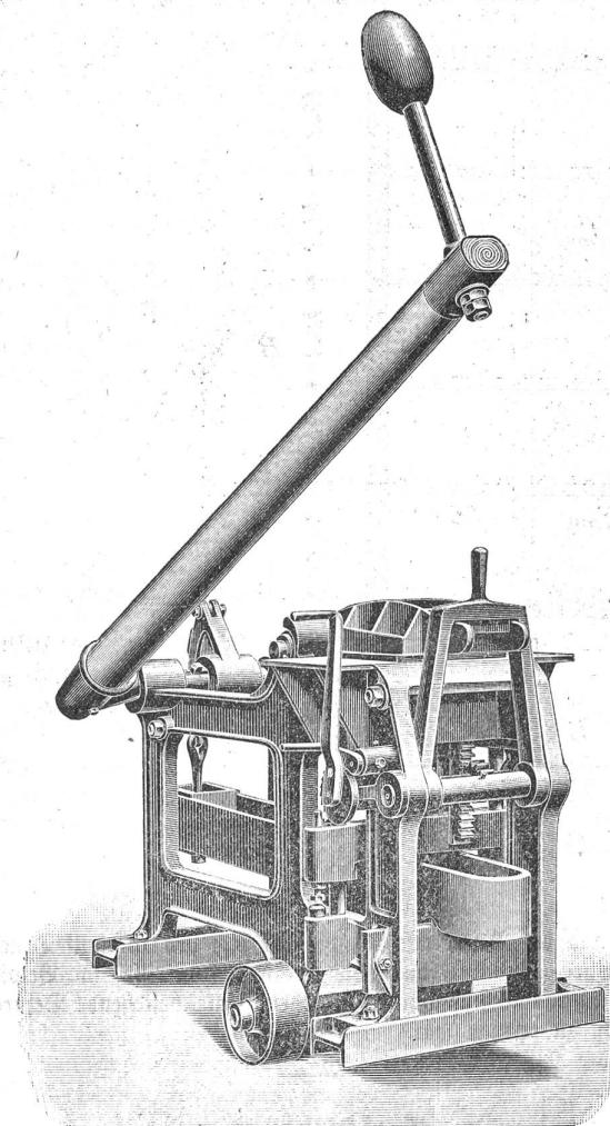
Eine spezielle Handkurbel mit Welle und Zahnrädern dient dazu, den Preßkolben fürs Herausnehmen geprägter Steine zu heben.
