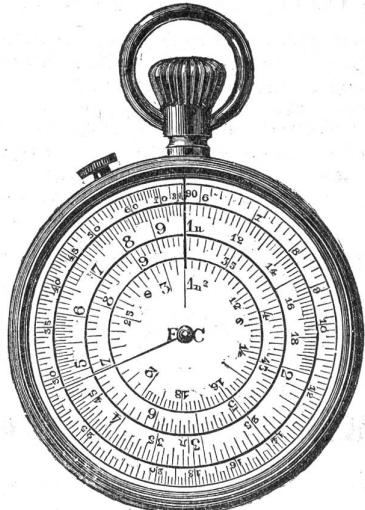
und Sinusscalen; die fixe Scheibe drei Kubusscalen und Logarithmenscalen. — Vermittelst des Knopfes dreht man die bewegliche Scheibe und mit dem seitlichen Drücker werden wie bei der Remontoiruhr zwei Nadeln mit correspondierender Stellung auf beiden Scheiben gestellt. Eine feststehende Nadel am Kopfe der Uhr bildet den Index.
