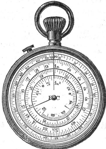
und Sinusscalae; die fixe Scheibe drei Kubusscalae und Logarithmenscala. — Vermittelst des Knopfes dreht man die bewegliche Scheibe und mit dem seitlichen Drücker werden wie bei der Remontoiruhr zwei Nadeln mit correspondierender Stellung auf beiden Scheiben gestellt. Eine feststehende Nadel am Kopfe der Uhr bildet den Index.
