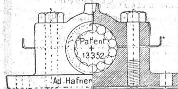
Diese einfachsten aller Kugellager können bei den meisten Maschinen und Transmissionen etc. mit dem grössten Vorteil verwendet werden, da in Folge der fast auf Null reduzierten Reibung ein sehr leichter Gang erzielt und daher sehr viel Kraft erspart wird. Nach dem gleichen System fabriziere auch Leerrollen und Stellringe.
