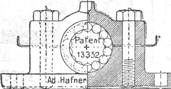
Diese einfachsten aller Kugellager können bei den meisten Maschinen und Transmissionen etc. mit dem grössten Vorteil verwendet werden, da in Folge der fast auf Null reduzierten Reibung ein sehr leichter Gang erzielt und daher sehr viel Kraft erspart wird. — Nach dem gleichen System fabriziere auch Leerrollen und Stellringe. Zur Abnahme obiger Maschinenteile nach jedem beliebigen Mass empfiehlt sich bestens
